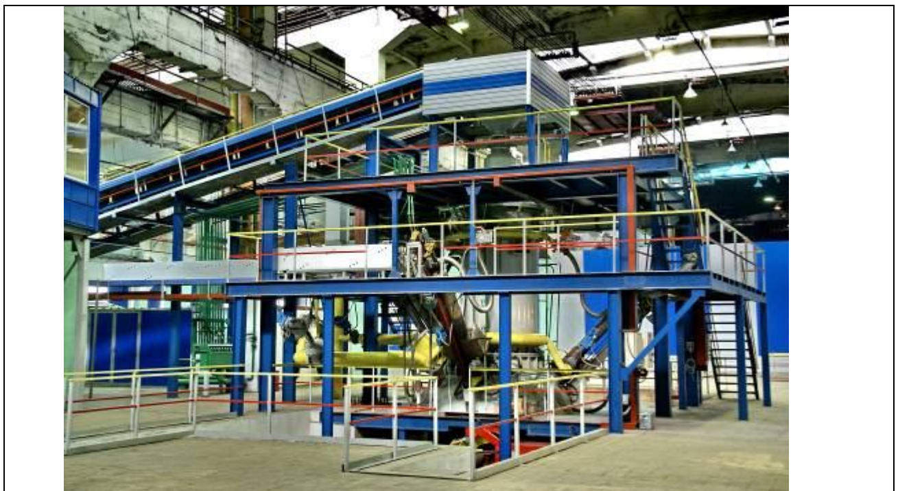
Рисунок 6. Плазменная шахтная печь конструкции ЗАО НПП «ЭПОС» мощностью 1,5 МВт для производства силикомарганца, запущенная в апреле 2009 г.
